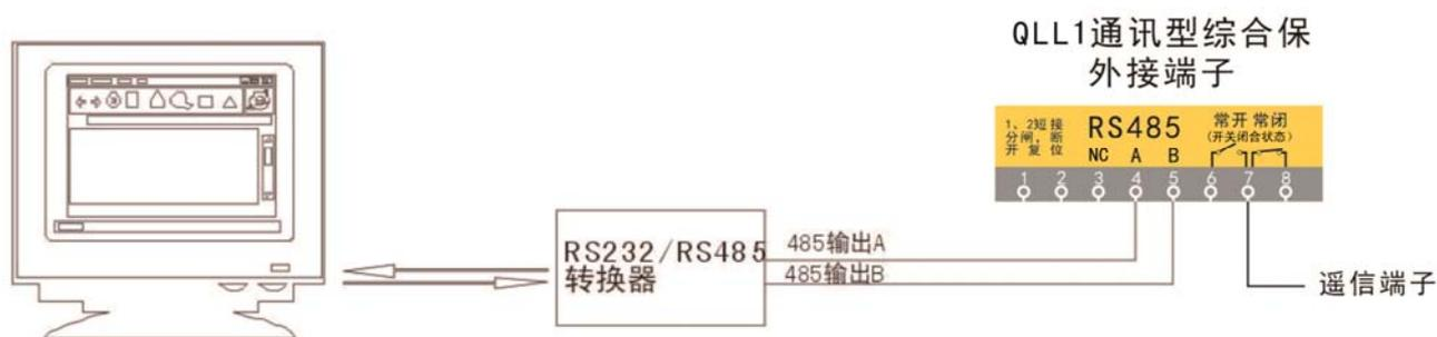
QLL1 系列可通讯断路器接线说明；上位机（个人电脑）的 RS232 串行接口通过 RS232/RS485 转换器后的输出端子 A、B 通过双绞线与下位机（QLL1）的外接端子 A、B 相连即可。如果与其它具有 RS485 端口的设备相连时，只需将它们的同名端用双绞线相连即可。
